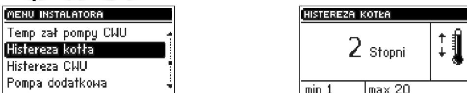
Этот режим служит для установки гистерезиса заданной температуры Ц.О. Это разница между температурой входа в цикл поддержки и температурой возврата в рабочий цикл (напр. когда заданная температура установлена на 60°C, а гистерезис составляет 3°C, переход в цикл поддержки наступит после достижения температуры 60°C, а возврат в цикл работы наступит после понижения температуры до 57°C).
