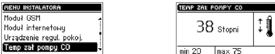
Этот режим служит для настройки температуры включения насоса ц.о. (это температура, измеряемая на котле). Выше настроенной температуры включается насос. Выключение насоса произойдет после понижения температуре на котле ниже температуры включения (минус гистерезис 2°C).
