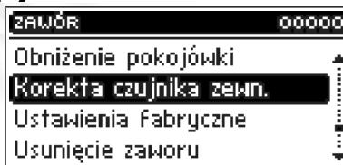
Корректировка наружного датчика проводится при установке или после длительного пользования регулятором, если температура в помещении, отображаемая на датчике, отличается от фактической. Диапазон регулировки: от -10 до +10 °C с точностью до 1°C.
