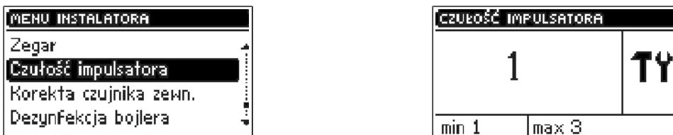
При помощи этой настройки можно изменить чувствительность ручки импульсатора в пределе от 1 до 3 (где 1 - наивысшая чувствительность).
