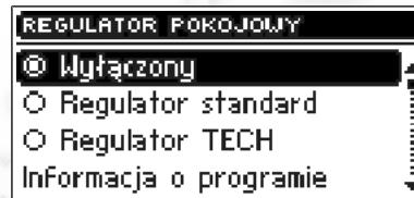
При помощи этой настройки пользователь может выключить или включить соответствующий вид комнатного регулятора, выбирая между стандартным регулятором (традиционным двухуровневым) и регулятором TECH (со связью RS и возможностью настройки заданных температур).
