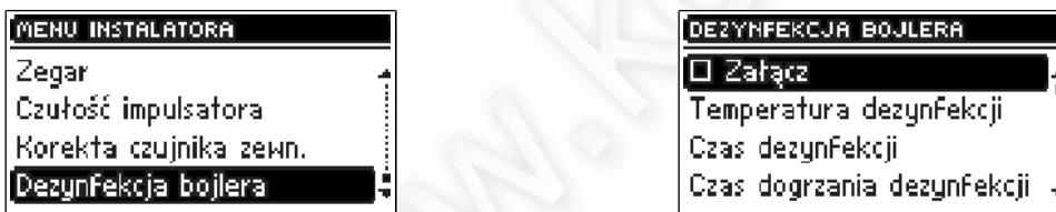
Термическая дезинфекция состоит в повышении температуры до требуемой температуры для дезинфекции - мин. 60°C во всей системе горячего водоснабжения.
