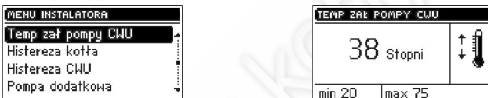
Этот режим служит для настройки температуры включения насоса гор. воды. (это температура, измеряемая на котле). Выше настроенной температуры (напр. 38°C) включается насос и работает в зависимости от выбранного режима работы. Выключение насоса произойдет после понижения температуры на котле ниже температуры включения (минус гистерезис гор. воды 2°C), в этом случае насос выключится при 36°C на котле.
