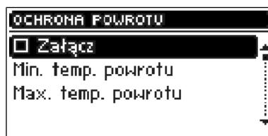
После включения защиты возврата следует настроить максимальную и минимальную температуру возврата для защиты котла. Эта функция позволяет предотвратить вскипание воды в короткой циркуляции котла и защищает от слишком холодной воды, возвращающейся из главного цикла, которая могла бы стать причиной низкотемпературной коррозии котла.
