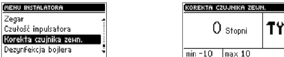
Корректировка проводится она при установке или после длительного пользования контроллером, если температура в помещении, отображаемая на датчике, отличается от фактической. Диапазон регулировки: от -10 до +10 ОС.
