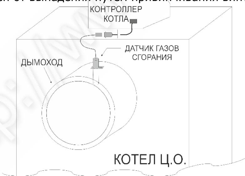
Вид питающих выходов и датчиков контроллера ST880zPID:
